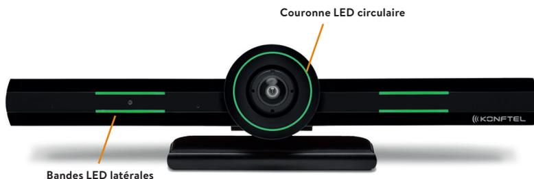
La caméra Konftel CC200 est équipée de deux rangées de bandes LED latérales à l'avant avec une couronne LED circulaire autour de l'objectif de la caméra. Les voyants affichent différentes couleurs et effets d'animation en fonction de l'état de la caméra. La caméra prend en charge le zoom de la vidéo depuis l'interface web et l'unité de contrôle à distance. Lorsque la caméra effectue un zoom avant, vous pouvez également faire un panoramique et incliner la caméra de façon numérique.
